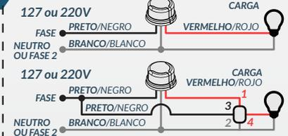
1 e 2 bobina contactora 127 ou 220 V / bobina de contactor
