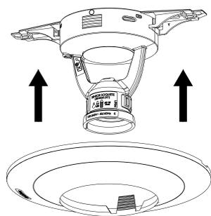
Para efetuar a ligação, é muito simples, basta conectar o fio preto (F/LI) na fase e o fio azul (N) no neutro ou fase 2 da instalação elétrica.
