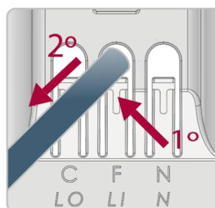
Encaixe o cabo, com decape de entre 8-10mm, pressionando-o no borne correspondente até fixar
