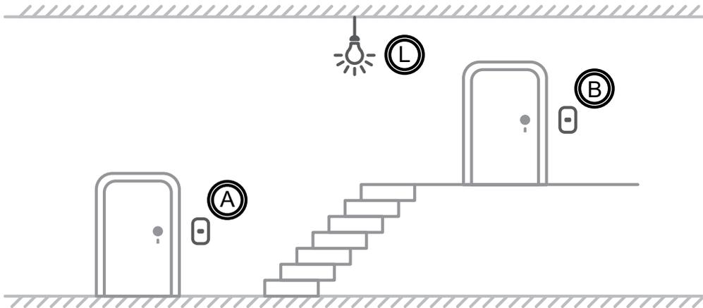
Funcionamento básico: sempre que se mexer no estado da Chave A ou Chave B, é trocado o estado da lâmpada L.
