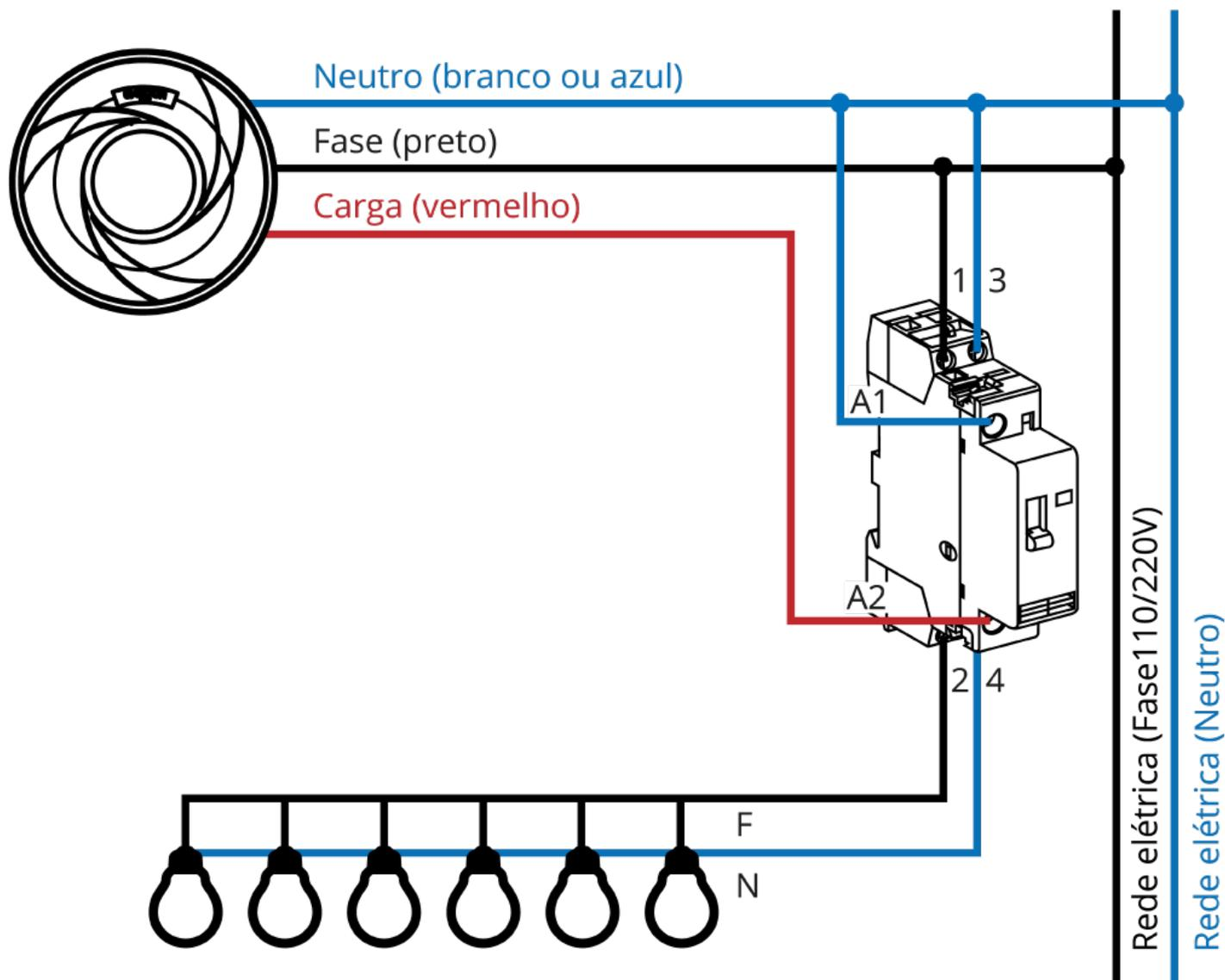
**Atenção:** para potências maiores utilize um contator da Exatron conforme sugerido neste diagrama esquemático.
