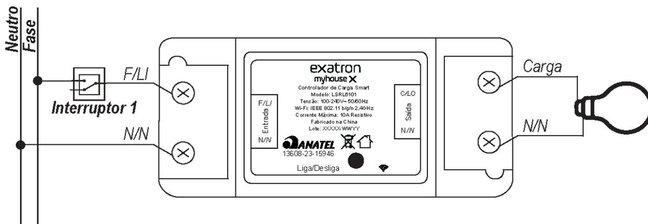
c) Instalação elétrica do produto com mais de uma carga:
