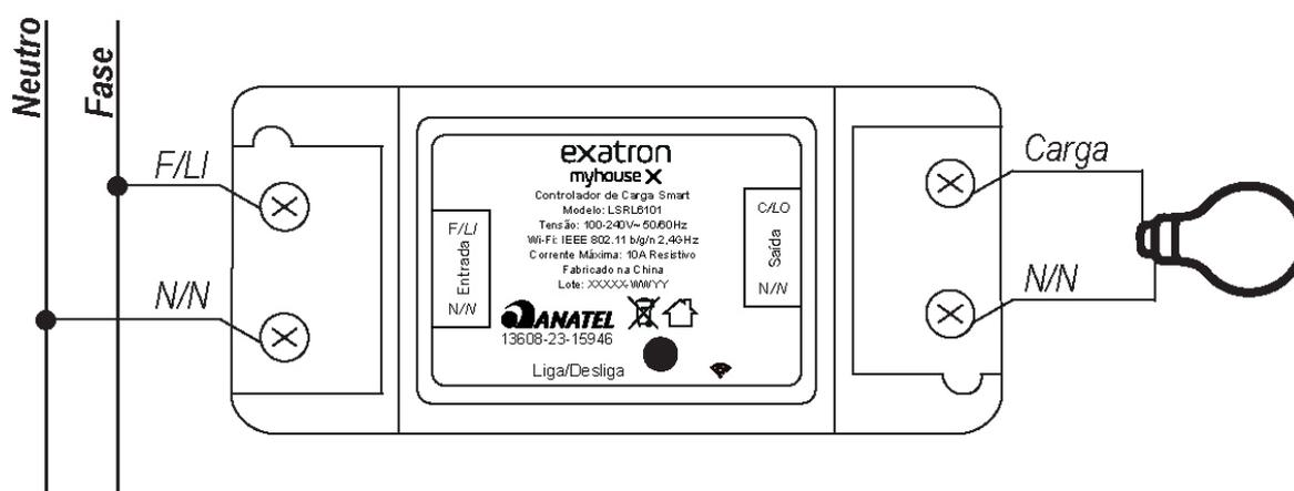
b) Instalação elétrica do produto com uma carga e um interruptor externo:
