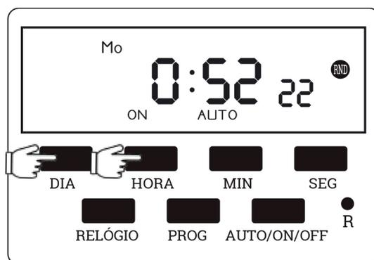
6.2. Contagem regressiva: pressione os botões "DIA" e "SEG" simultaneamente para entrar no modo contagem regressiva. O display mostrará "d ON" no lado esquerdo, sinalizando que o timer está neste modo.
