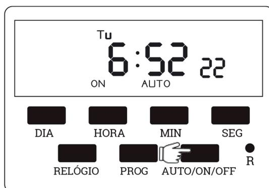
5.4. Desligado automático: pressione o botão “ON/AUTO/OFF” até que apareça no display “OFF” juntamente a “AUTO”. Neste modo, o timer permanecerá desligado até que a próxima programação para ligar entre em ação.
