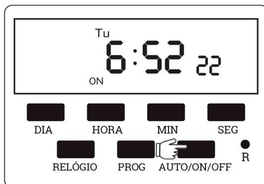
5.2. Modo Desligado: pressione o botão “ON/AUTO/OFF” até que apareça no display “OFF”. Neste modo, o timer não estará fornecendo alimentação para seu equipamento ligado. O LED vermelho apagado indica que o timer está com a sua saída desenergizada.
