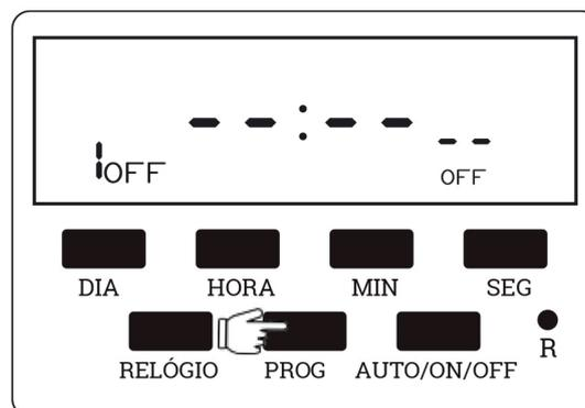
3.4. Pressione "SEG", "MIN", "HORA" e "DIA" para ajustar a semana, hora, minutos e segundos em que o timer ligará para configuração "1OFF". Obs.: Se quiser ajustar mais programações de LIGAR/DESLIGAR, continue pressionando "PROG". O timer aceita um máximo de 20 ajustes diferentes para ligar e desligar, totalizan-
