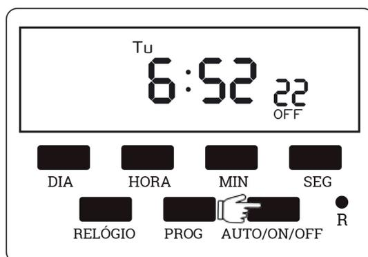
5.3. Ligado Automático: pressione o botão “ON/AUTO/OFF” até que apareça no display “ON” juntamente a “AUTO”. Neste modo, o timer estará fornecendo alimentação para seu equipamento ligado. O timer desligará o fornecimento de energia, assim que a próxima programação para desligar entre em ação.
